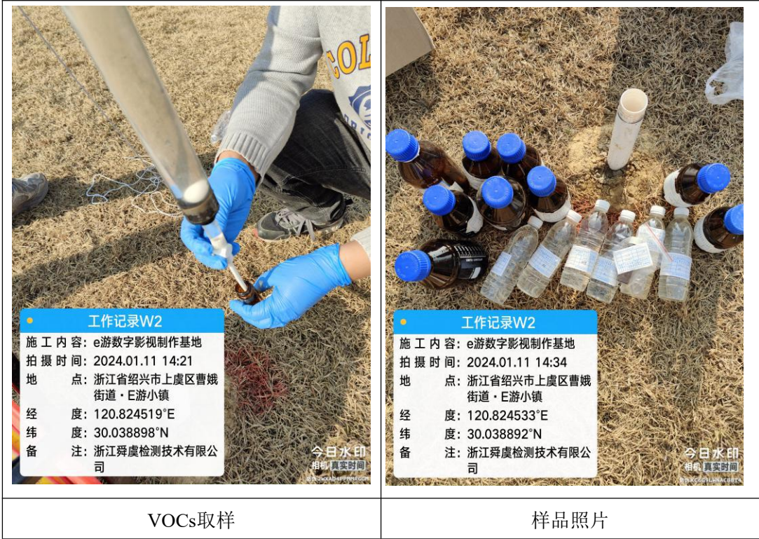
图 5.4-4 地下水采样照片
