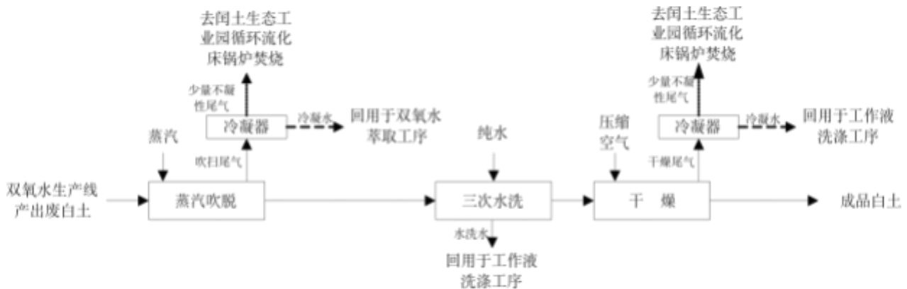
图 4.1-6 活性氧化铝 900 吨资源综合利用生产工艺流程及产污环节示意图
